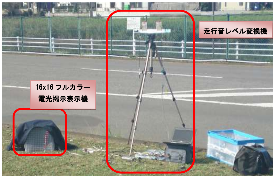
図 4-10 走行音感知システムの実験風景
