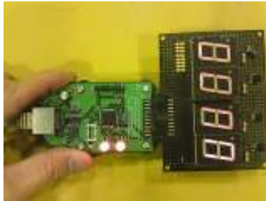
図 4-5 7セグ LED 表示 Pandora の基板外見
