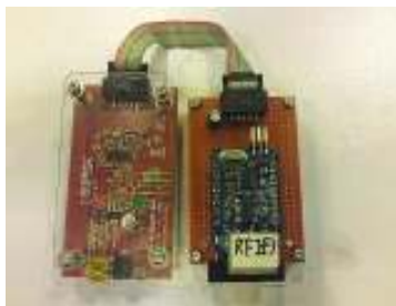
図 4-8 RFID 読み取り Pandora の基板外見
