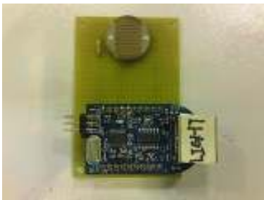
図 4-7 光センサー Pandora の基板外見
